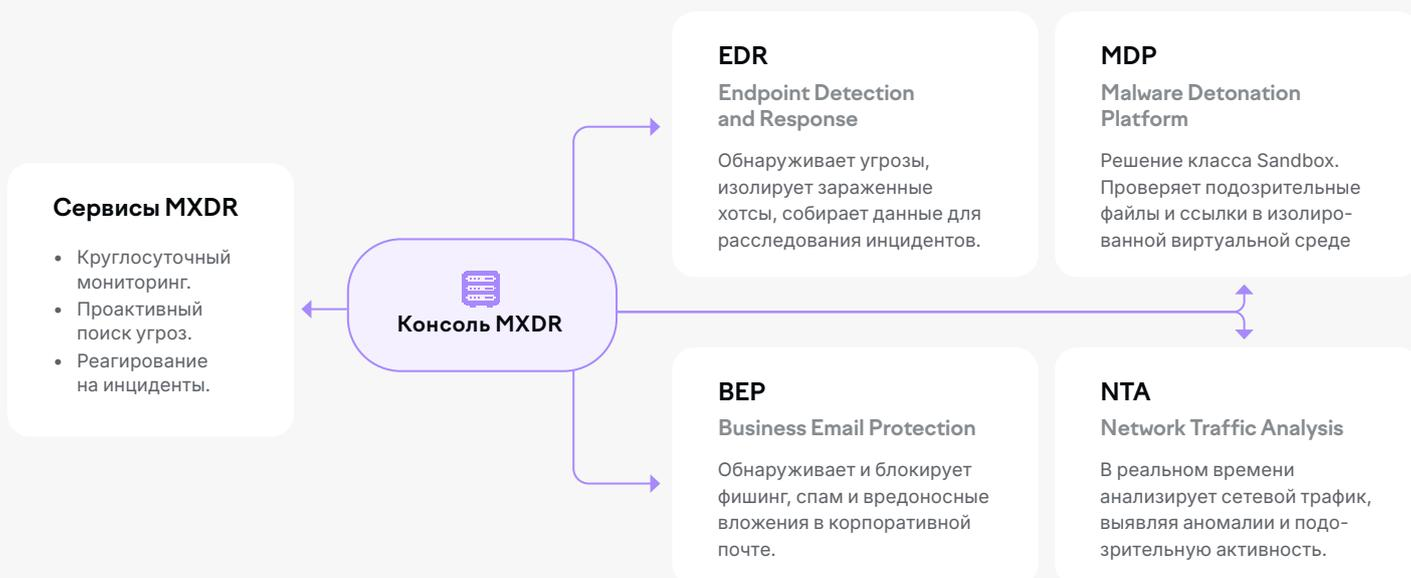
**Managed XDR** устроен как конструктор и состоит из четырех модулей — MDP, NTA, EDR, BEP, а также сервисов.
